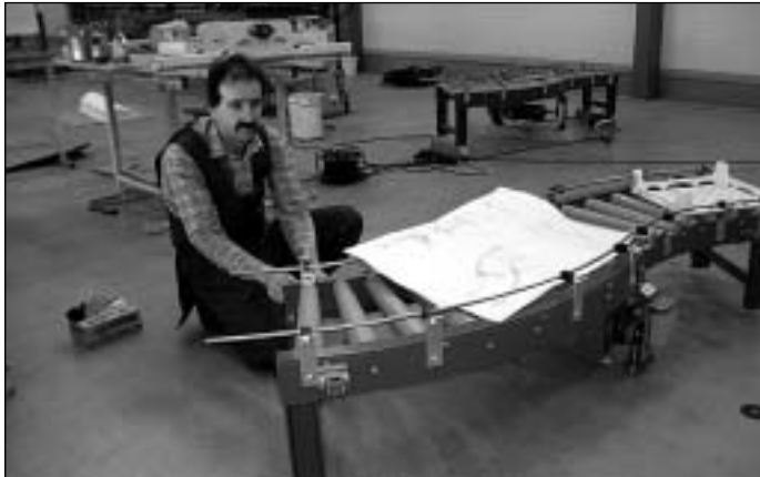
Pesmeli avaras tootmishoones monteeritakse toodang enne tellijale saatmist kokku, et töö kvaliteeti tegelikkuses kontrollida.
