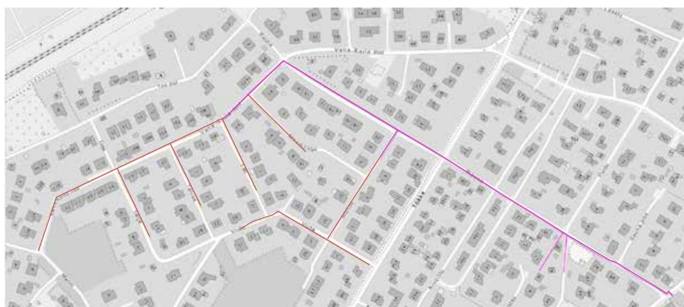
Piirkonnas on tehtud AS Tallinna Vee trasside kaamerauuringud, mis ei ole seal ühtegi katkist toru tuvastanud. Ühisveevärgi veest reostust leitud ei ole.
